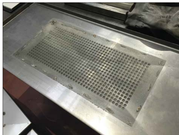
Particolare pannello inox di aerazione con rete antinsetto saladata
