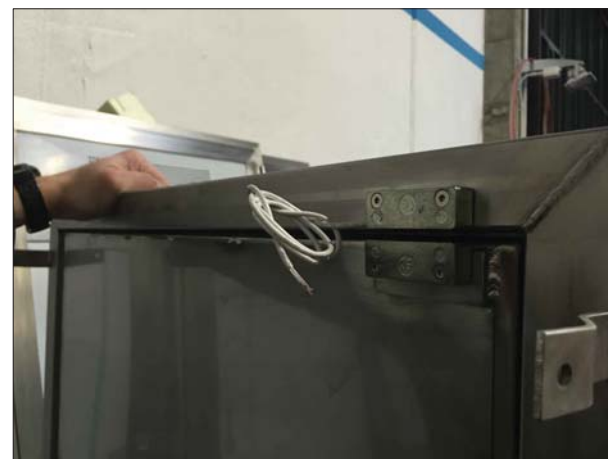
Sensore apertura porta con collegamento elettrico
